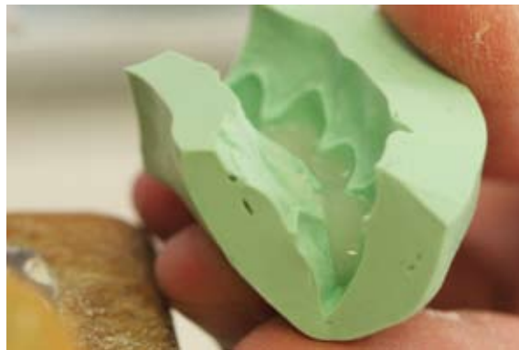
Fig. 29: evidenza della fluidità dell'impasto che permette alla resina di scorrere all'interno della mascherina in silicone
